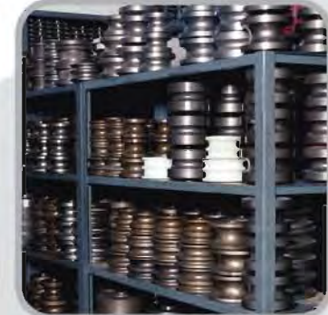
• Özel Alüminyum Kıvrma için Vals Topları • Special Rolls For Aluminium Profiles • СПЕЦИАЛЬНЫЕ РОЛИКИ ДЛЯ АЛЮМИНОВОГО ПРОФИЛЯ
