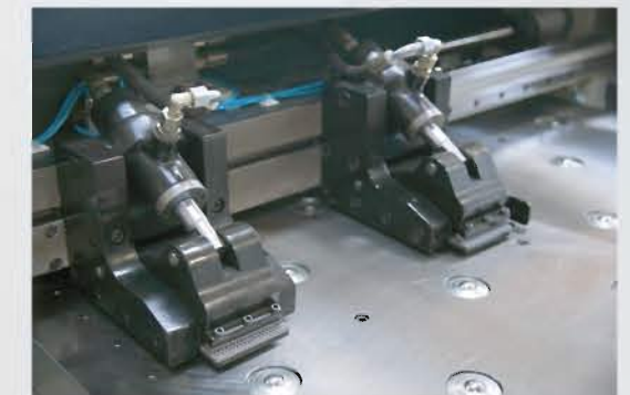
*Hidrolik Sıkımalı Çeneler *Material Holder With Hydraulic Clamp *ДЕРЖАТЕЛЬ С ГИДРАВЛИЧЕСКИМ ЗАХВАТОМ
