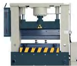
AT Pres özel abkant bıçağı ile AT Press with optional press brake tooling AT ПРЕСС С ДОПОЛНИТЕЛЬНЫМ ПРИСПОБЛЕНИЕМ ДЛЯ ГИБКИ
