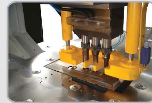
* 3 Kafalı Zimba Tasarımı * 3 HEAD PUNCHING DESIGN * КОНСТРУКЦИЯ С 3-МЯ ПРОБИВНЫМИ ГОЛОВКАМИ
